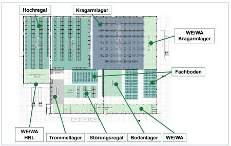
Parallel zur Mietobjektsuche wurden die entwickelten Ideallayouts an verschiedene Gebäudeanforderungen (z. B. Bodenlast, Brandschutz, Einbringung der Regale) angepasst und Machbarkeiten geprüft.
